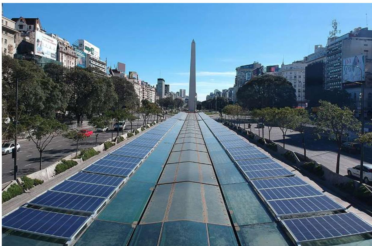
Foto: Paneles solares instalados en el techo de una parada del Metrobus de la Avenida 9 de Julio en la Ciudad de Buenos.
